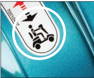
Freilaufhebel nach unten: - elektrische Fahrposition - Bremse ist EINGESCHALTET!
