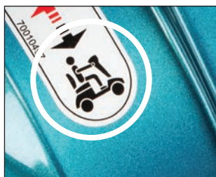
Levier d'embrayage vers le bas: - Position de conduite électrique - Les freins sont activés
