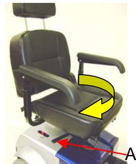
Une fois le siège revenu en position normale, il se verrouille automatiquement. Ainsi, le siège ne pourra tourner spontanément pendant la conduite.
