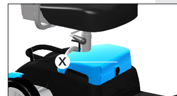
Contact chargeur batterie
