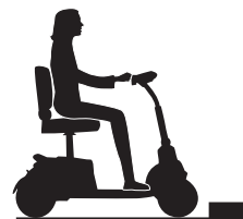
Anfahrt an eine Schwelle
